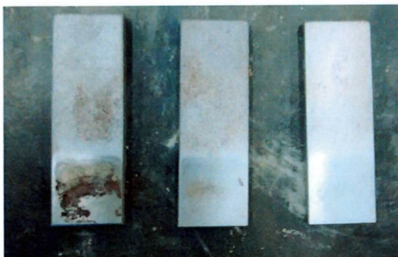
Figura 15 – Placas utilizadas no ensaio de abrasão, da esquerda para direita: alimentação, fração magnética e fração não-magnética
